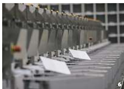
5, 6, 7 Obsluha má někdy co dělat, aby linku, která třídí tempem 30 tisíc obálek za hodinu, stihala plnit. Do jednotlivých boxů padají obálky určené pro konkrétního doručovatele v daném regionu.
