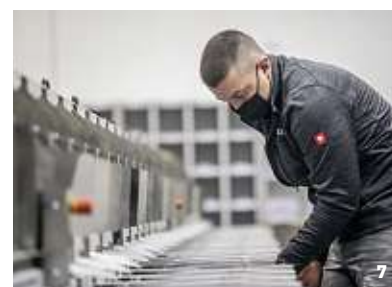
5, 6, 7 Obsluha má někdy co dělat, aby linku, která třídí tempem 30 tisíc obálek za hodinu, stihala plnit. Do jednotlivých boxů padají obálky určené pro konkrétního doručovatele v daném regionu.
